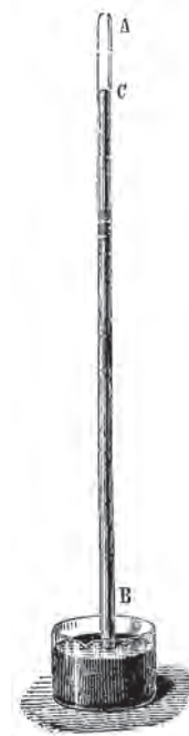
Ртутный барометр Эванджелисты Торричелли. Над поверхностью ртути в верхней части запаянной трубки (в области AC) – вакуум («торричеллиевая пустота»)
